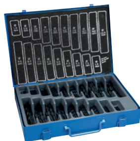
Zestaw wiertel krętych DIN 338 · Typ N · walcowane rolnkowo · prawotnące · 1-10 mm (po 10 wiertel spiralnych 1,0-8,0 mm, 0,5 mm rosnąco i po 5 wiertel spiralnych 8,5-10,0 mm, 0,5 mm rosnąco) w walizce metalowej
