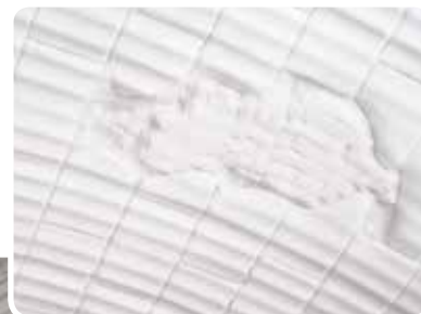
Uzupełnianie ubytków w wykładzinie z tlenku glinu
